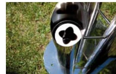
Les réducteurs de flamme peuvent être placés au dessus de chaque brûleur cylindrique. Ne pas enlever le réducteur quand il est chaud. Risque de brûlure.
